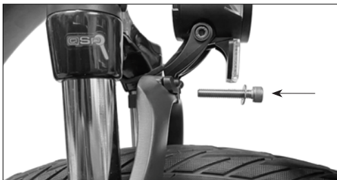
Fig. 20a: Install the top fender mounting bolt.
